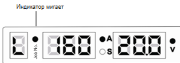
Рис. 3-38 Пользовательский интерфейс, указывающий, что сварочные диапазоны регулировки параметров заблокированы.
