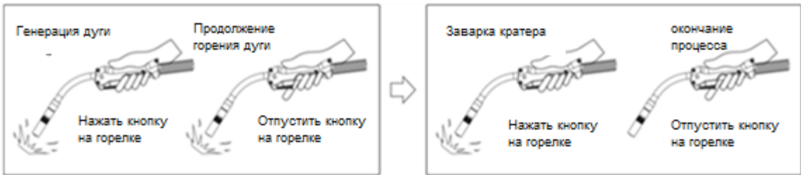
Рис. 3-11 показывает процедуру сварки
