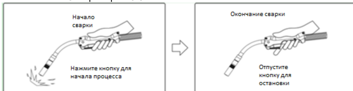
Рис. 3-6 показывает процедуру сварки.
