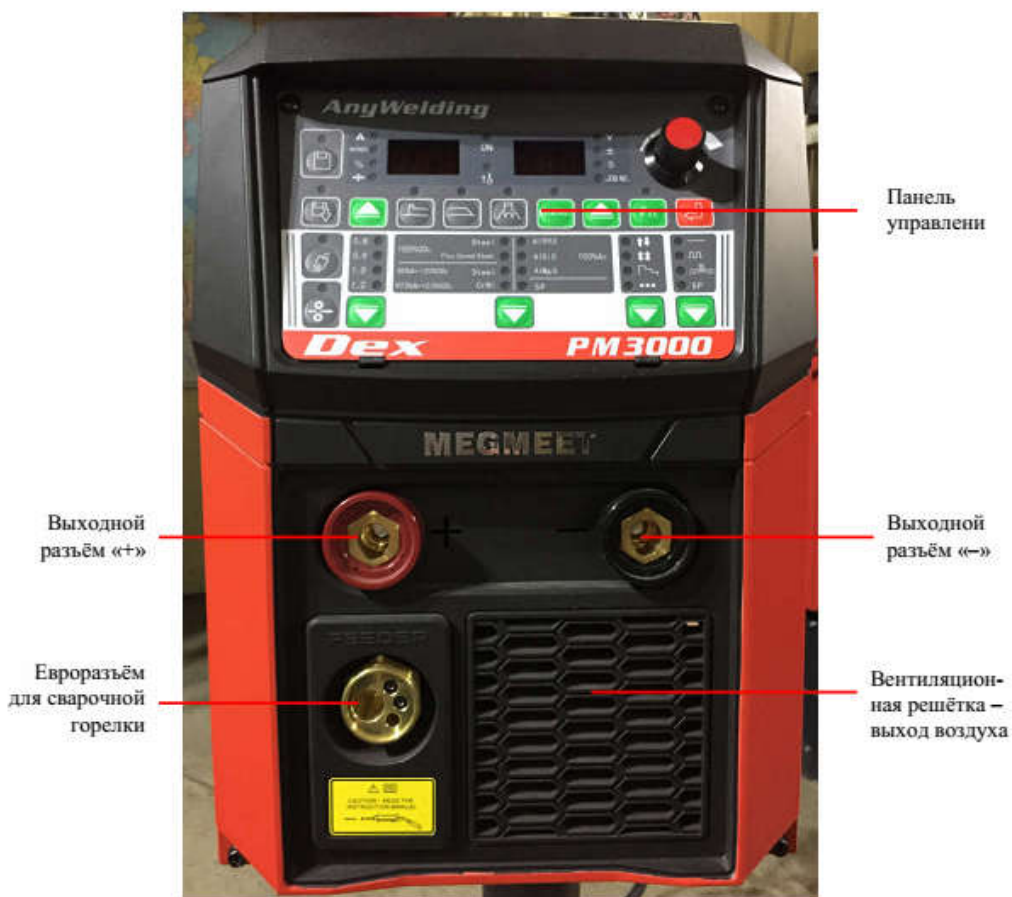
Рисунок 1-2. Передняя панель сварочного полуавтомата
