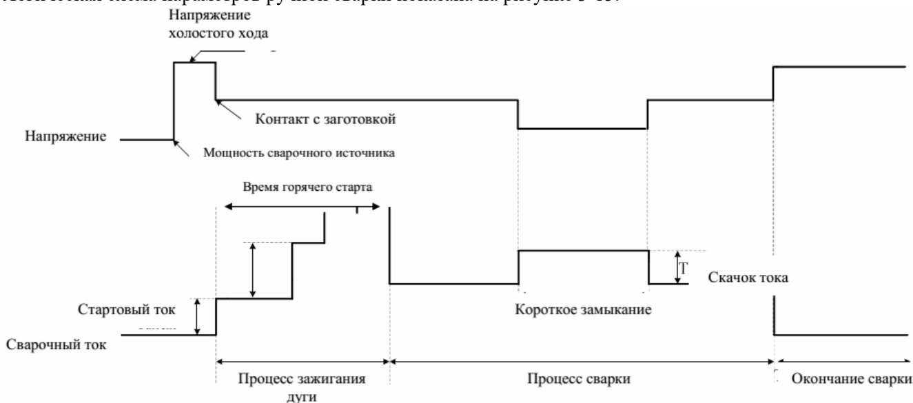
Рисунок 3-15. Схема логики ручной сварки
