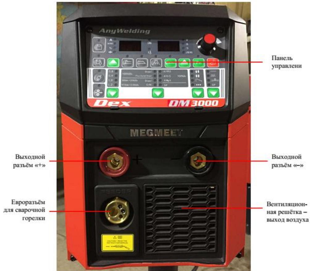
Рисунок 1-2. Передняя панель сварочного полуавтомата
