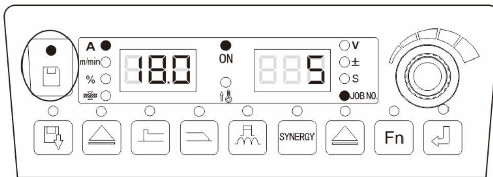
Рисунок 3-10. Настройка сохранения параметров сварки
