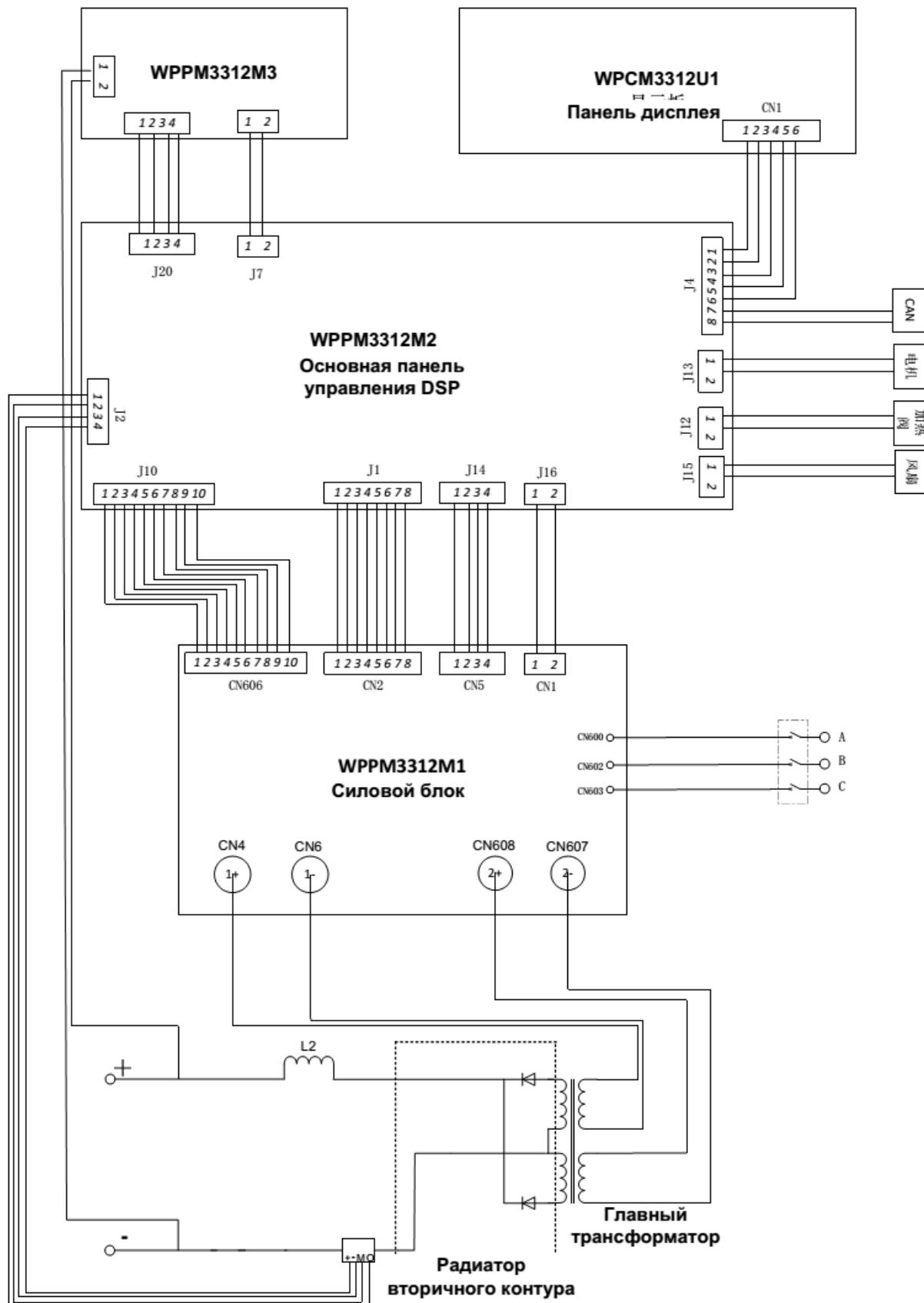
Рисунок П2-1. Электрическая блочная схема сварочного полуавтомата
