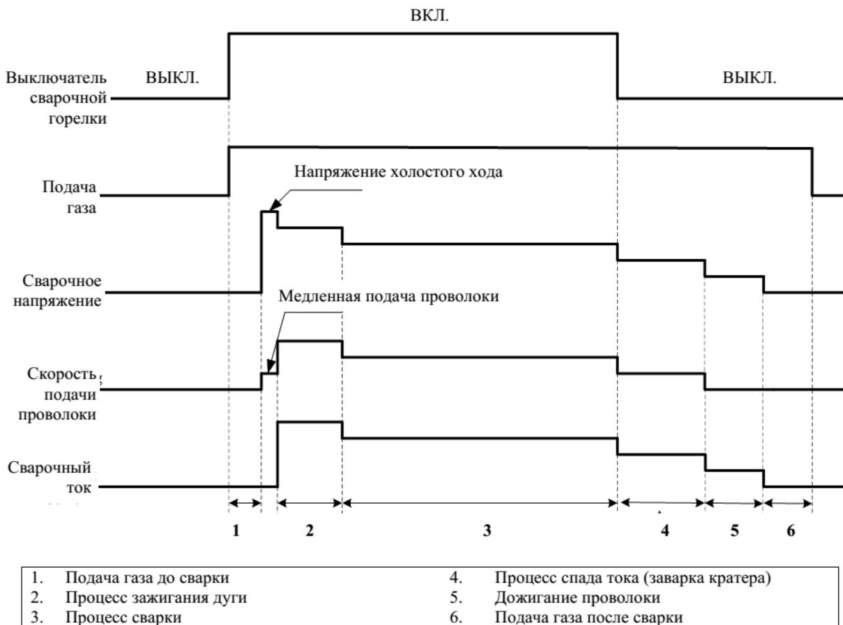
Рисунок 3-7. Логическая схема режима сварки 2 такта
