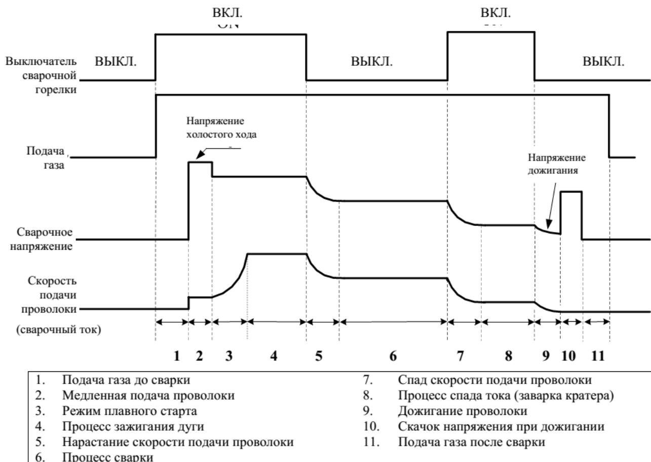
Рисунок 3-12. Логическая схема параметров сварки на постоянном токе (режим 4T – 4 такта)
