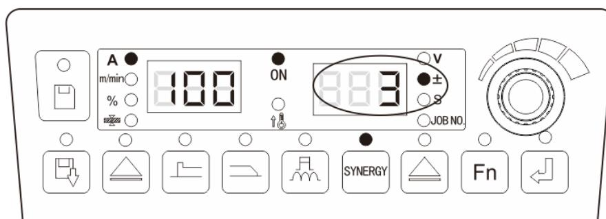
Рисунок 3-2. Интерфейс соответствия значения изменения напряжения режима "Совместно"
