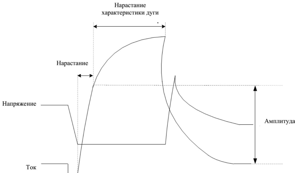
Рисунок 3-13. Увеличение сварочного тока – режим "ArcForce" ("Форсирование дуги")
