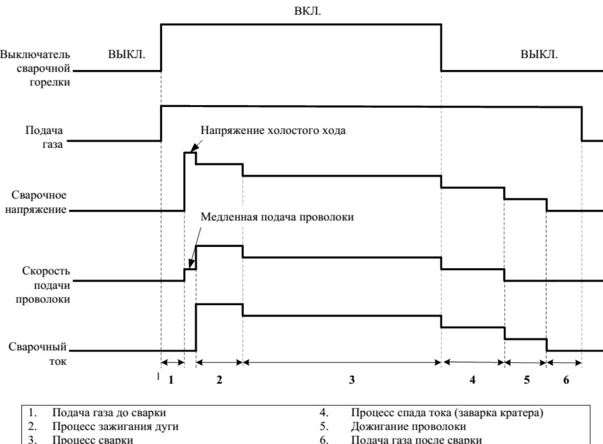
Рисунок 3-8. Логическая схема режима сварки 4 такта
