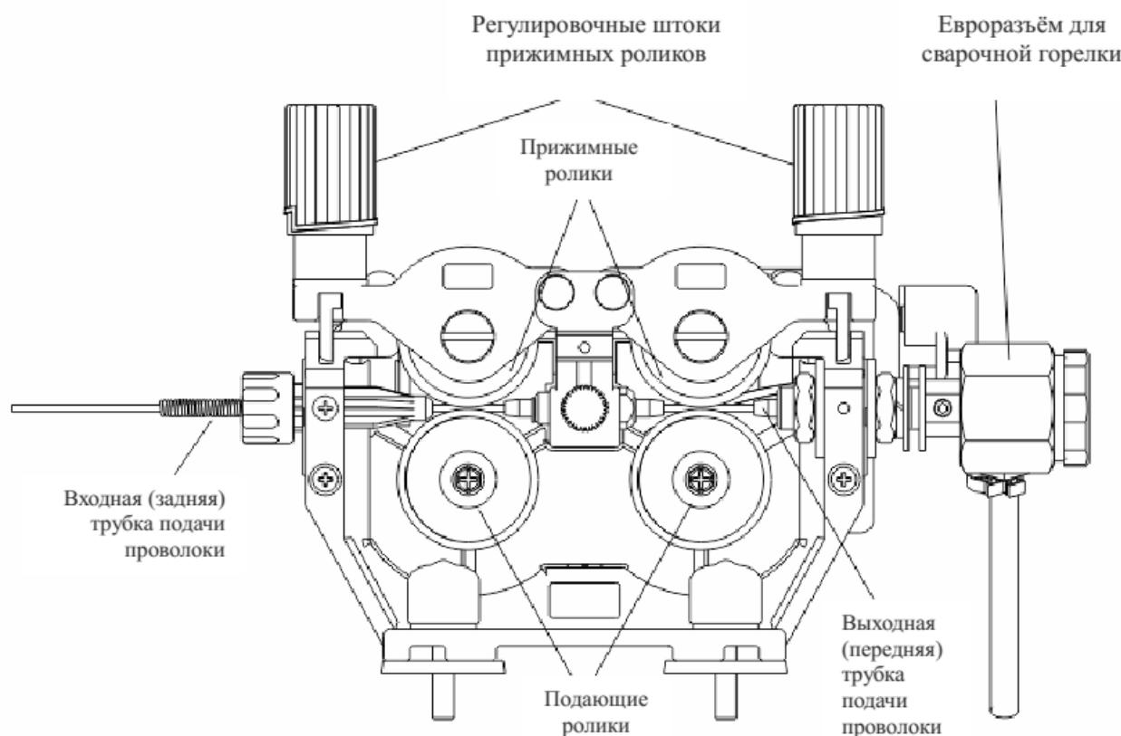
Рисунок 2-3. Схема 4x-роликового механизма подачи проволоки сварочного полуавтомата Dex PM3000(R)
