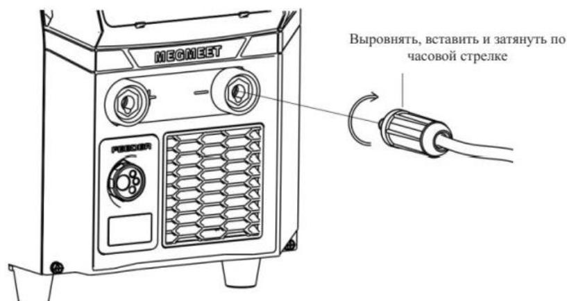
Рисунок 2-2. Схема подключения обратного сварочного кабеля ("земля") к заготовке
