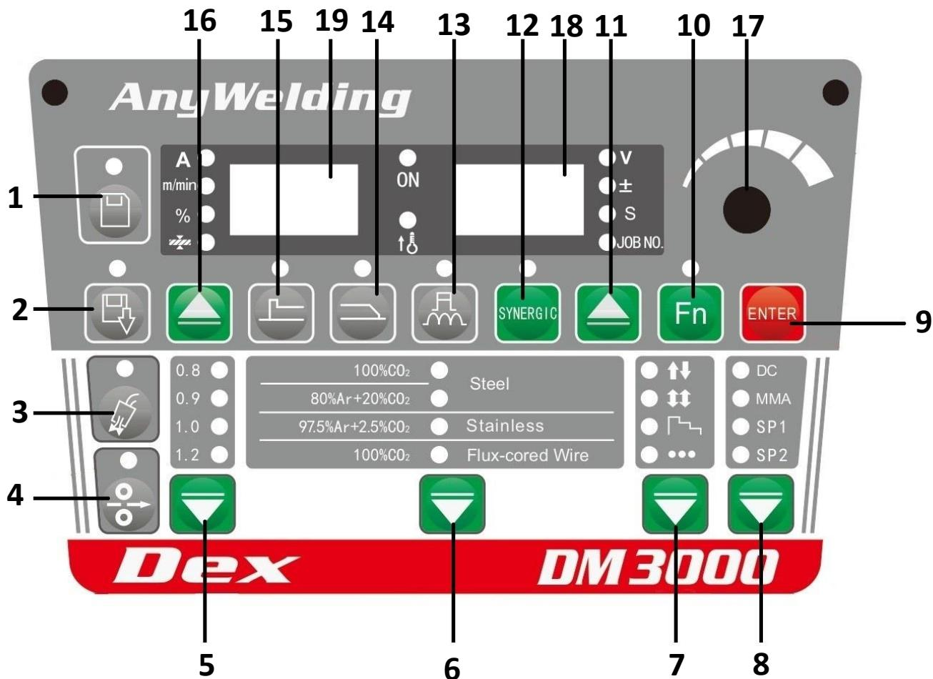
Рисунок 3-1. Функциональная панель управления сварочного полуавтомата Dex DM3000
