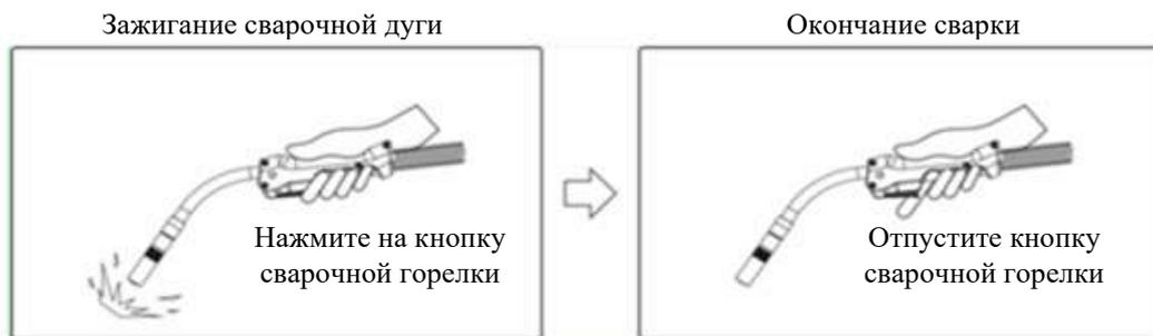
Рисунок 3-6. Принципиальная схема сварки без режима заварки кратера
