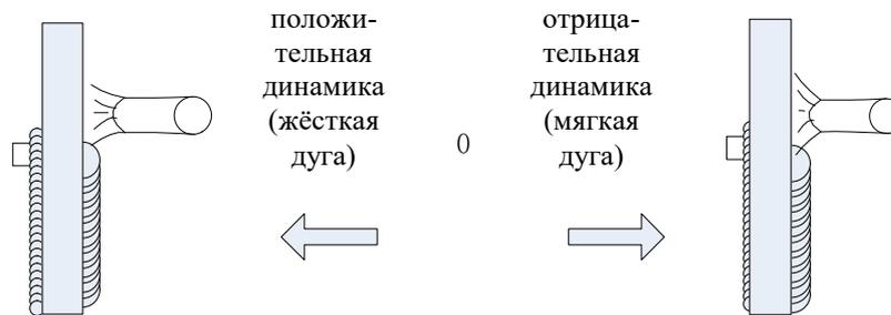
Рисунок 3-15. Схематическая диаграмма динамики дуги
