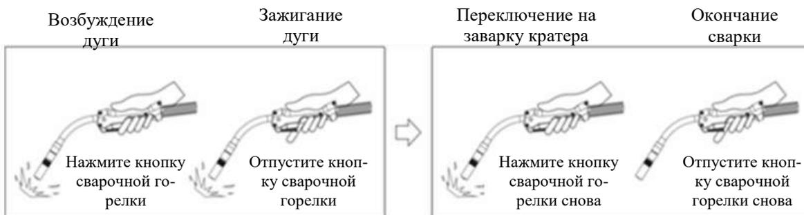
Рисунок 3-6. Принципиальная схема сварки с режимом заварки кратера
